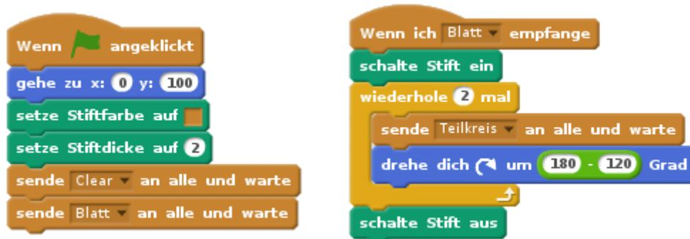
Abbildung 32: Programm für das Zeichnen eines Blattes
