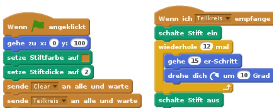
Abbildung 31: Programm für das Zeichnen eines Teilkreises
