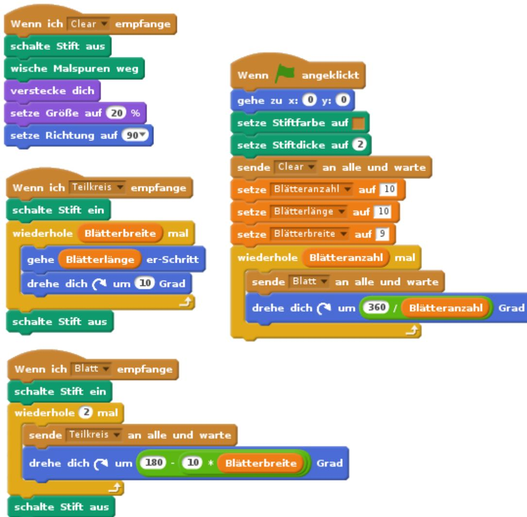
Abbildung 36: Vollständiges Programm mit Angabe von Blattlänge und -breite
